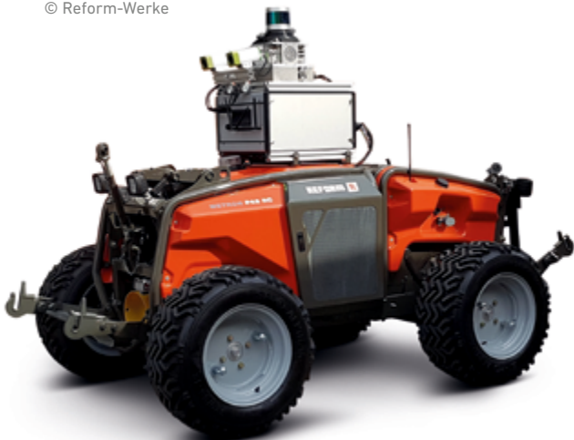
Abb. 17 – Reform Metron P48 RC mit Automatisierungsmodul und Sensorausstattung © Reform-Werke
